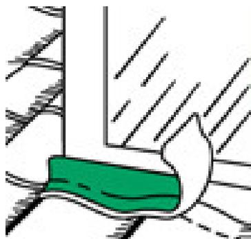
**Nastro di tenuta stagna per acqua ed aria**, composto da uno strato di mastice butilico desivo a freddo ed un film per la protezione da agenti aggressivi. La parte adesiva è protetta da un leggero film siliconato da togliere. Ideale per la sigillatura di colmi, scossaline di comignoli, tegole; la giunzione di licernai, tettoie vetrate, verande, porte e telai di finestre; la riparazione di grondaie e condotte di scarico.
